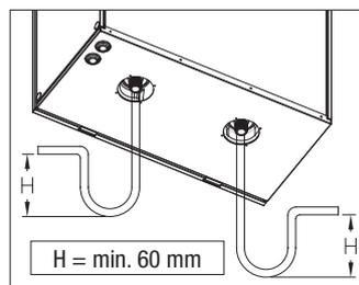
Raccorder les joints de vidange de condensation (G 3/4" M) placés dans le côté inférieur de l'unité à un coude en U (ou similaire) sur le tuyau de drainage de condensation. Dans le cas où fermer le joint non utilisé au moyen du bouchon de vidange fourni. S'assurer que cette opération est bien faite.
