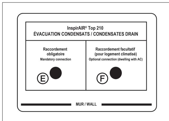
Aldes recommande de raccorder les condensats en E et F uniquement lorsque l'unité est installée dans un logement climatisé, dans lequel l'été, les condensats peuvent se créer de l'autre côté de l'échangeur.
