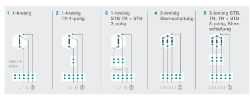
Achtung: Nach fachgerechtem Einbau bietet der STB einen ausreichenden Übertemperaturschutz. Der STB ist jedoch kein Schutz gegen Trockenbetrieb. Hierfür müssen Schutzsysteme wie Niveaureguliersysteme o. ä. installiert werden.
