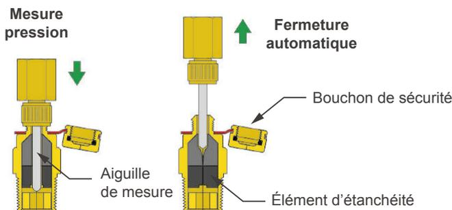
La mesure de différence de pression s'effectue avec des aiguilles que l'on enfonce dans les prises de pression qui sont des zones de rétention et où les bactéries peuvent proliférer, de l'eau pouvant être contaminée circule alors dans l'appareil de mesure. Si l'appareil de mesure n'est pas désinfecté à chaque mesure, la contamination se propagera à chaque nouvelle mesure.
