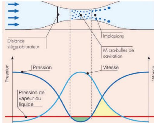
Obturateur d'une vanne traditionnelle détérioré par un phénomène de cavitation. Selon les lois de Bernouilli, la vitesse augmente au passage de l'obturateur, et la pression diminue. Si la pression diminue en dessous de la pression de vapeur saturante de l'eau, il y a formation de micro-bulles qui vont imploser et détruire l'obturateur.
