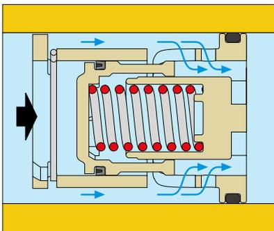
Si la pression différentielle se trouve dans la plage de travail, le piston comprime le ressort et permet d'obtenir une section de passage libre suffisante pour l'écoulement régulier de **débit nominal** pour lequel l'AUTOFLOW® a été conçu.
