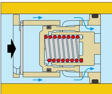
Dans cette situation, le piston comprime totalement le ressort et ne laisse donc que l'ouverture à géométrie fixe pour le passage du fluide.
