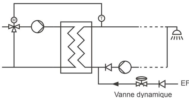
Le calcul de besoin d'une installation d'ECS se fait sur des bases statistiques. En cas d'erreur, si les besoins ont été sous évalués pour une installation de production instantanée, la température de la boucle peut chuter et engendrer des risques sanitaires (débit trop important pour l'échangeur, donc température de départ trop faible).
