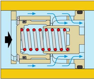
Dans ce cas le piston reste en équilibre sans comprimer le ressort et laisse au passage du fluide la plus grande section libre disponible. En pratique, le piston agit comme un régulateur fixe et, par conséquent, le débit qui traverse l'AUTOFLOW® ne dépend que de la pression différentielle.
