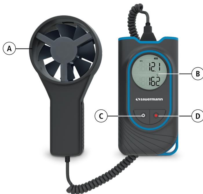
**A** Sonde à hélice avec 2 m de câble
