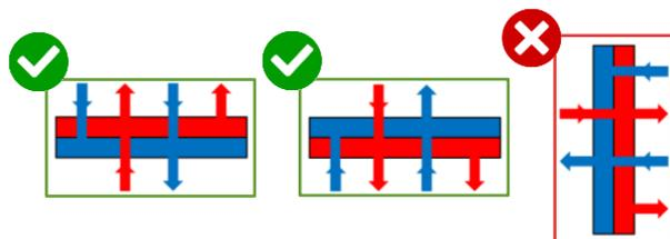
⚠ Dans le collecteur à 3 et 5 circuits, les raccords côté primaire sont inversés par rapport aux autres modèles (2 et 4 circuits)
