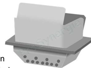
Le creuset est placé dans une chambre de réserve de cendre qui a également pour fonction de canaliser et répartir l'arrivée de l'air comburant.
