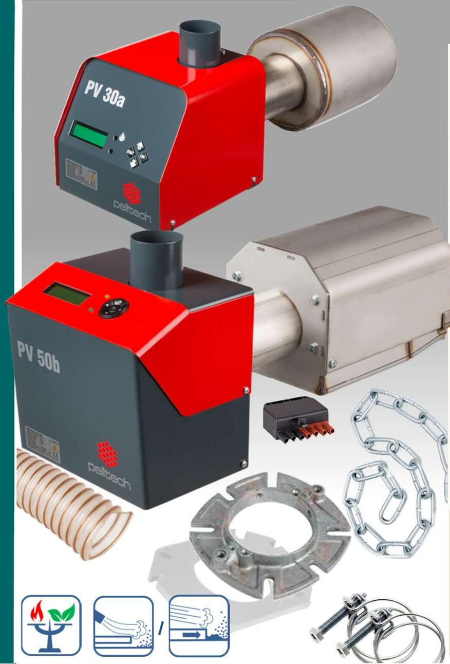
**Les brûleurs PELLTECH ont été conçus pour le remplacement standard de brûleurs fioul ou gaz :** ils se fixent avec une bride Européenne, disposent d'un passage de buse Ø90 mm, d'une Fiche 7 broches pour le raccordement électrique et sont pilotés par l'aquastat de la chaudière
