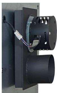
Celui-ci est fixé sur la bride de la buse de sortie des fumées à l'arrière de la chaudière par l'intermédiaire de 4 vis filetées et 4 écrous (M8). Il peut être orienté dans 3 positions : départ de fumée en dessous du moteur, à 90° à droite ou à gauche ; suivant le besoin de l'installation.
