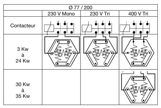
La borne de terre est au centre du thermoplongeur
