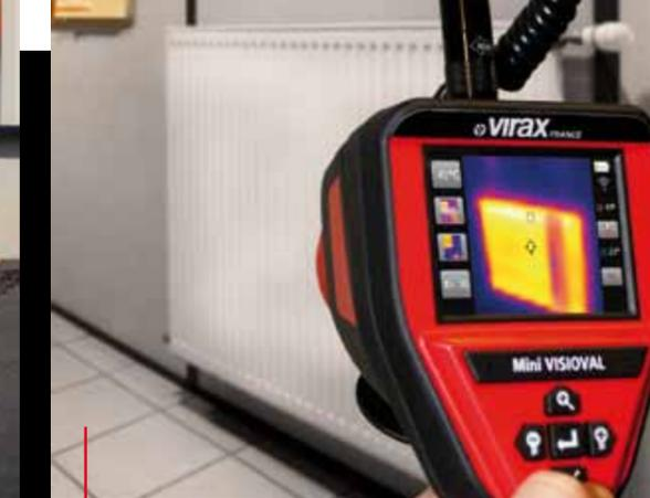
**Diagnostiquer thermiquement** et rapidement les mauvais fonctionnements d'un réseau.
