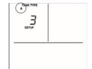
RÉGLAGE 3 - Réglage du type de la cuve. Sélectionnez le type de cuve, c-à-d. A, B ou C à l'aide des touches  $\Delta/\nabla$  afin que le type soit correspondant à celui que vous avez noté au-dessus. Appuyez sur ENTER pour enregistrer.
