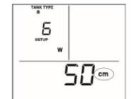
RÉGLAGE 6 - (ne concerne que les réservoirs de type B et C) - Réglage de la largeur de la cuve (cm). Veuillez consulter le tableau ci-dessus pour obtenir la largeur de la cuve et puis ajustez la quantité affichée en cm à l'aide des touches  $\Delta/\nabla$ . Appuyez sur ENTER pour enregistrer.
