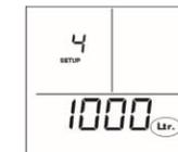
RÉGLAGE 4 - Réglage de la capacité de la cuve (L). Veuillez consulter le tableau ci-dessus pour obtenir la hauteur de la cuve et puis ajustez la quantité affichée en litres à l'aide des touches  $\Delta/\nabla$ . Appuyez sur ENTER pour enregistrer.
