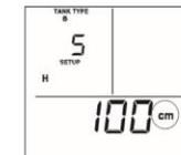
RÉGLAGE 5 - Réglage de la hauteur de la cuve (cm). Veuillez consulter le tableau ci-dessus pour obtenir la hauteur de la cuve et puis ajustez la quantité affichée en cm à l'aide des touches  $\Delta/\nabla$ . Appuyez sur ENTER pour enregistrer. Veuillez noter que si vous avez sélectionné le type « A » le RÉGLAGE 6 sera sauté automatiquement.
