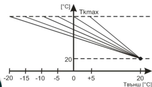
Dans ce cas, le régulateur fonctionne sans thermostat d'ambiance. Le point de consigne pour la température de l'eau de la chaudière est formé en fonction des lectures d'un capteur externe.
