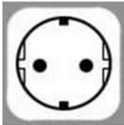
Fig. 10a – prise de type Schuko
