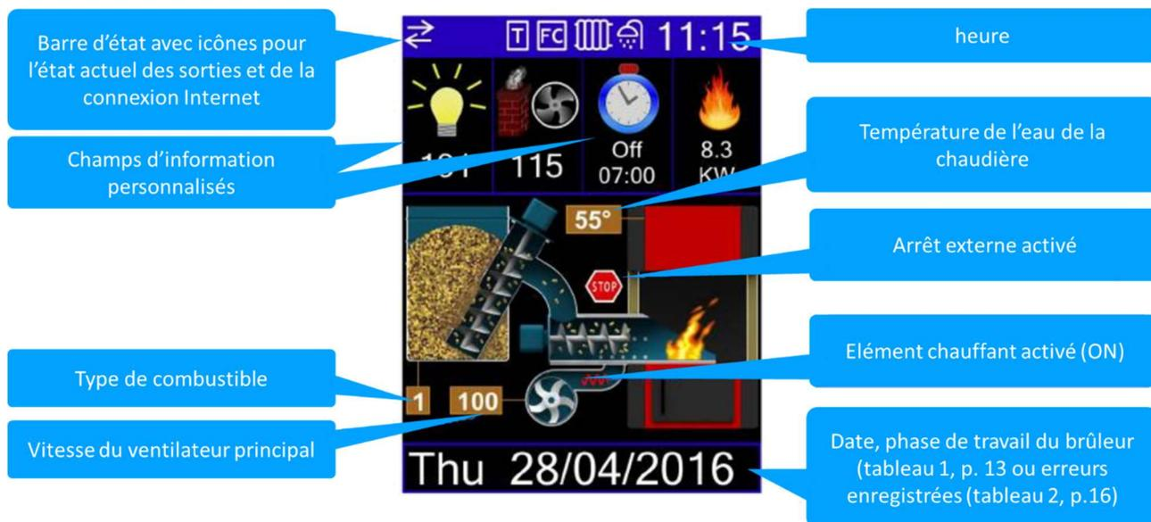
Les animations sur l'écran principal indiquent quand l'un des moteurs, soit celui de la vis sans fin, soit celui du ventilateur principal est actuellement actif. L'image de la flamme animée dans la chaudière indique en temps réel qu'une combustion est détectée par la cellule photoélectrique.
