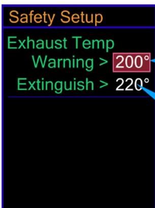
Si la température des gaz d'échappement est supérieure à 200 ° C, le contrôleur affiche un message d'avertissement
