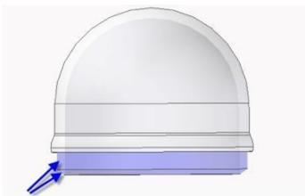
Avant de placer le nouveau dôme, il est nécessaire de lubrifier le filetage avec du silicone. Lors du remplacement du dôme, on doit veiller à ce que le dôme soit vissé fermement jusqu'au dernier pas de vis. Dans le cas contraire, l'étanchéité de la tête de la caméra n'est pas garantie et le fonctionnement peut être perturbé par la pénétration d'eau ou de saletés.
