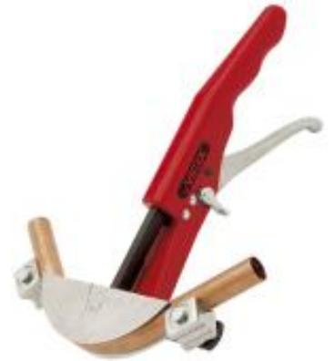
**CONSEIL** : *Pour tube cuivre recuit au chalumeau : Ne recuire que la partie cintrée pour ne pas affaiblir le tube au niveau des contre-formes. Ne pas recuire le tube à l'endroit des contre-formes : risque de déformation.*
