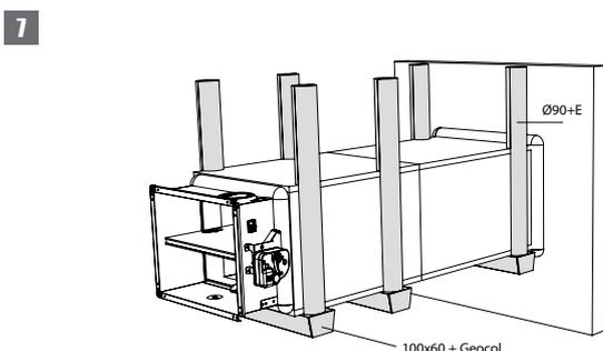
7. Les tiges filetées sont protégées par ½ coquilles en staff Ø 90 mm et maintenues entre elles par colle et polochonnage. La traverse est protégée par un profilé en « U » de protection en GEOFLAM 100 x 60 mm, collé à la sous-face du conduit par du plâtre pour collage de type GEOCOL (GEOSTAFF).
