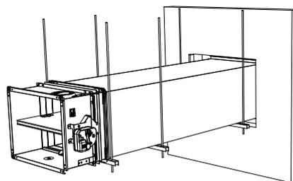
3. L'ouverture de dimensions maximales « A » est réalisée au travers de la paroi.
