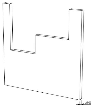
3. Les clapets peuvent être installés à distance minimale d'une dalle/d'un plafond ( $\geq 25 \text{ mm}$ ), d'une paroi ou d'un autre clapet ( $\geq 50 \text{ mm}$ ).
