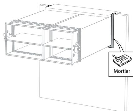
11. Colmatez la réservation du côté des distances minimales à l'aide de panneaux rigides de laine de roche ( $\geq 150 \text{ kg/m}^3$ ) sur une profondeur de 400 mm (150 mm du côté mécanique de la paroi).
