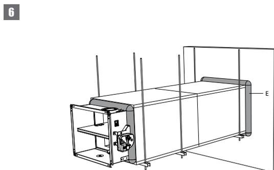
6. La protection en staff GEOFLAM F s'arrête à 15 mm du mur. L'espace libre entre le mur et la protection en staff est comblé par bourrage de polochons (mélange de plâtre et de filasse). Ce bourrage est également appliqué sur la jonction entre le conduit et le tunnel du clapet.
