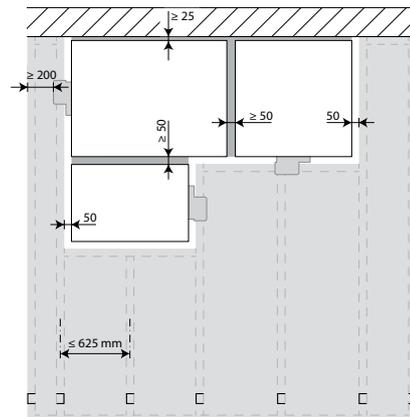
4. Les clapets peuvent être installés à distance minimale d'une dalle/d'un plafond ( $\geq 25$  mm), d'une paroi ou d'un autre clapet ( $\geq 50$  mm).
