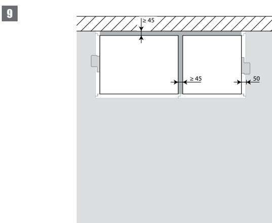
9. Les clapets peuvent être installés à distance minimale d'une dalle/d'un plafond ( $\geq 25$  mm), d'une paroi ou d'un autre clapet ( $\geq 50$  mm).
