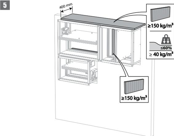
5. Installez et fixez les clapets dans la réservation. Colmatez la réservation du côté des distances minimales à l'aide de panneaux rigides de laine de roche ( $\geq 150 \text{ kg/m}^3$ ) sur une profondeur de 400 mm (150 mm du côté mécanique de la paroi).
