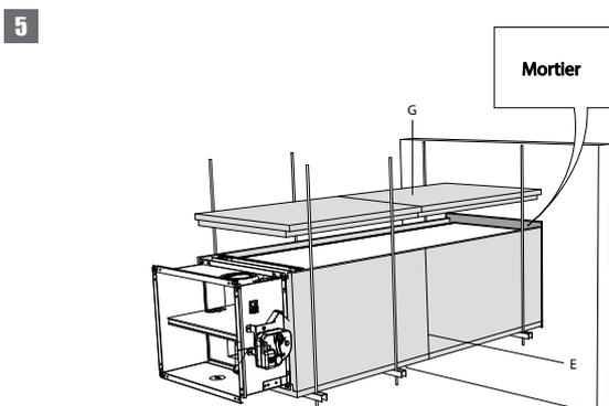
5. La réservation autour de la gaine dans la paroi est remplie par du mortier ordinaire. La gaine traversante est recouvert de plaques de staff de référence GEOFLAM F d'épaisseur 45 mm ou GEOFLAM Light d'épaisseur 35 mm « G ». Les plaques sont fixées entre elles autour de la gaine par colle et polochonnage « E ». Le corps du clapet est également ainsi protégé sur une longueur de 120 mm.
