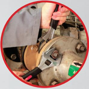
Design particulièrement approprié pour le serrage écrou/contre-écrou dans des espaces étroits.
