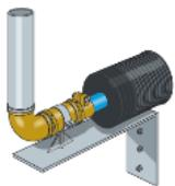
Des points fixes adéquats doivent être installés pour ancrer fortement les extrémités des canalisations (notamment aux pénétrations de mur). L'installation des points fixes est nécessaire et obligatoire afin de protéger l'installation et absorber les effets potentiels de la dilatation/rétraction des tubes caloporteurs en PER-A.
