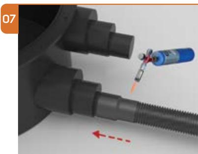
Placer le manchon thermorétractable sur les orifices d'entrée et la gaine. Utiliser un décapeur thermique ou un chalumeau (flamme molle) pour rétracter les manchons. Utiliser des gants de protection pour presser sur la gaine le manchon rétractable ramolli.
