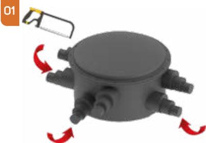
Couper les orifices d'entrée de l'UIC en tenant compte du diamètre de la gaine externe. Couper l'orifice d'entrée  $\varnothing$  120 pour gaine de 110 mm,  $\varnothing$  170 pour gaine de 140/160 mm et  $\varnothing$  235 pour gaine externe de 75/90/200/225 mm. Utiliser le RAS200/75 et RAS200/90 pour intégrer des gaines externes de  $\varnothing$  75 et 90 mm.
