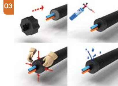
Enfiler les manchons thermorétractables sur les tubes caloporteurs et la gaine externe comme indiqué. Utiliser un décapeur thermique ou un chalumeau (flamme molle) pour rétracter les manchons. Utiliser des gants de protection pour presser sur la gaine le manchon rétractable ramolli.
