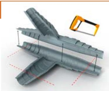
Couper les 2 demi-coques perpendiculairement en tenant compte du diamètre de la gaine externe. Chaque indentation correspond à un diamètre spécifique de la gaine externe. La demi-coque disposant d'une rainure est la demi-coque inférieure.
