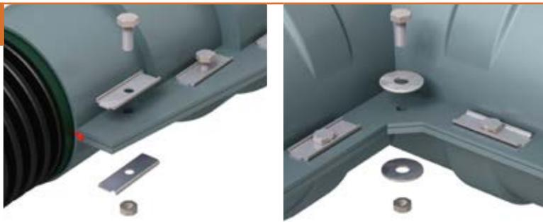
Utiliser les plaques en inox et les boulons en inox pour assurer le serrage sur les parties droites du kit d'isolation. Dans chaque coin, utiliser des rondelles en inox comme indiqué.
