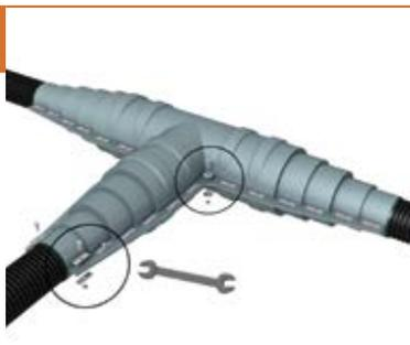
Joindre les 2 demi-coques en utilisant le kit de fixation fourni. Tous les boulons seront serrés jusqu'à ce que les 2 demi-coques soient parfaitement jointes et que le mastic colle déborde aux extrémités du kit d'isolation.
