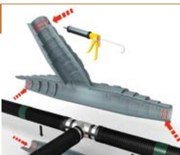
Appliquer 2 lignes du mastic colle fourni en respectant une épaisseur minimale de 5 mm et une largeur minimale de 4 mm aux différentes extrémités des 2 demi-coques.
