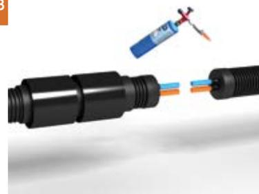
Utiliser un décapeur thermique ou un chalumeau (flamme molle) pour faire rétracter les manchons. Utiliser des gants de protection pour presser sur la gaine le manchon rétractable ramolli.
