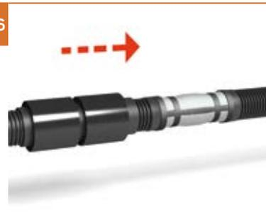
Faire coulisser le tube du kit d'isolation en I jusqu'à ce que la jonction entre les tubes pré-isolés soit parfaitement couverte. Faire coulisser les 2 manchets d'isolation de part et d'autre du tube du kit d'isolation en les positionnant de façon à ce qu'elles recouvrent pour moitié le tube du kit d'isolation et pour l'autre moitié la gaine externe.
