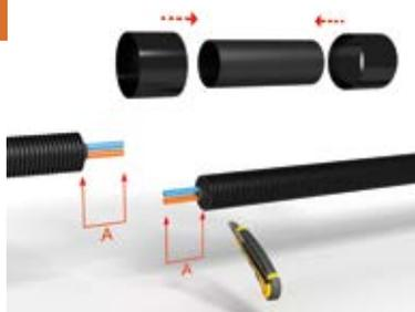
Découper soigneusement la gaine externe et les différentes couches d'isolation en faisant attention de ne pas endommager les tubes caloporteurs. La longueur à dénuder dépend du diamètre du tube caloporteur et est ici indiquée par la cote A.
