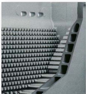
Echangeur/condenseur en aluminium (Al/Si/Mg) ultra-compact et complètement refroidi
