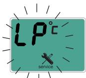
вместо температуры по Цельсию начинает мигать код неисправности (список "кодов ошибок" см. в разд. 4.6 инструкции по эксплуатации для установщика и техника по обслуживанию).
