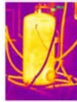
*Chargement thermique par le haut et nette stratification grâce au module d'échange breveté par la Cordivari.*
