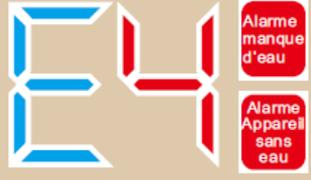
L'écran indique « E4 » lors d'une surchauffe de l'appareil. Dans ce cas, éteindre l'appareil pendant 20 minutes pour refroidir le système puis rallumer l'appareil.
