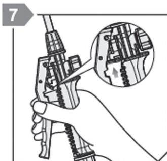
7 - Appuyez sur la gâchette pour démarrer la machine, poussez le système de blocage rouge pour la maintenir enfoncée.
