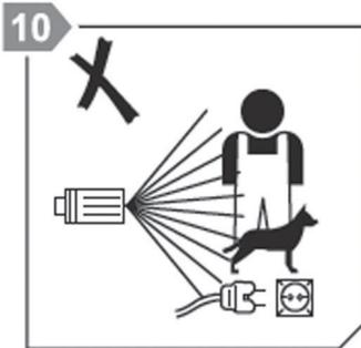
10. Ne vaporisez pas de pesticides contre le vent sur des personnes, des animaux ou des aliments. Ne pointez pas la buse sur un équipement sous tension ou vers la machine elle-même, pour éviter tout risque de court-circuit.
