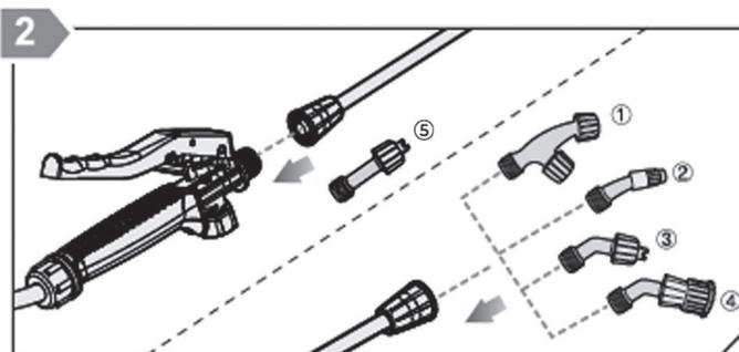
2 - Installez la lance et la buse (une sur quatre) sur la poignée du pistolet
