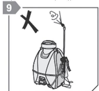
9 - Testez le pulvérisateur avec de l'eau la première fois, pour observer s'il y a une fuite à chaque joint et si la pulvérisation s'effectue correctement. Si tout va bien, il peut être utilisé normalement.
