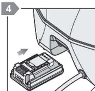
4 - Insérez le pack batterie totalement chargé dans le boîtier.
