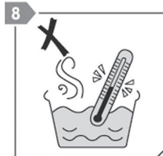
8 - La température de fonctionnement du vaporisateur ne devra pas dépasser 45°, et il ne devra pas être utilisé à une température
