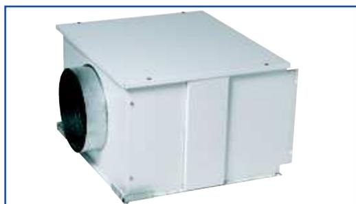
Le TVEC insufflation (type "F") est muni d'un filtre à poches d'une efficacité de filtration de 50 % au test ASHRAE opacimétrique (classe EU 5).
