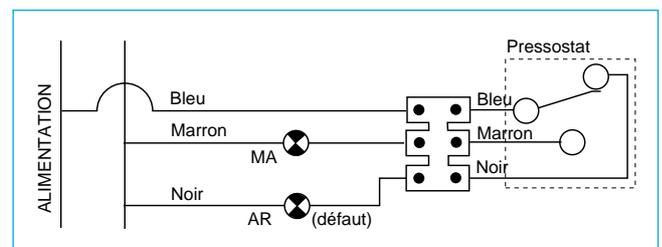
Installation avec DSC (VMC Gaz) : autre schéma disponible sur demande.
