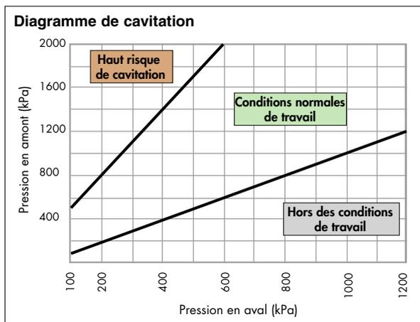
Afin de réduire au minimum le risque de cavitation à l'intérieur du réducteur, ce qui pourrait provoquer un mauvais fonctionnement du réducteur (risque d'érosion dans la zone d'étanchéité, vibrations et bruits), il est fortement conseillé de respecter les conditions de travail reportées dans le diagramme.
