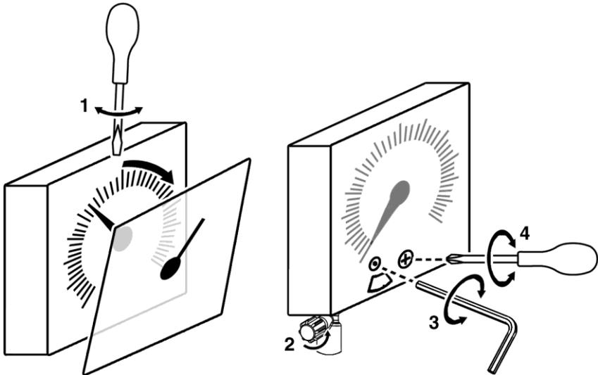
Le soin et la précision apporté au bon réglage de la hauteur du réservoir ainsi qu'à la correction du point zéro est garant de la précision de la mesure de niveau.
