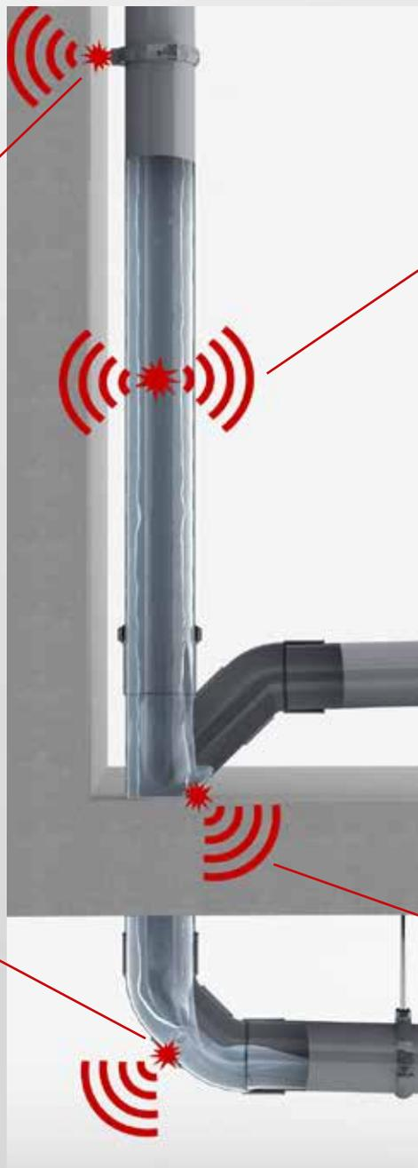
L'écoulement des eaux usées/vannes engendre des vibrations dans la chute qui contribuent au bruit solidien et génèrent également un bruit aérien.
