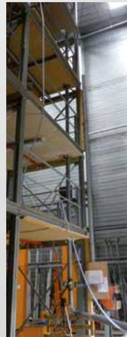
Test d'optimisation de la résistance au désiphonage de la culotte Chutunic® Maxicompact en configuration R+3 dans les laboratoires Nicoll.
