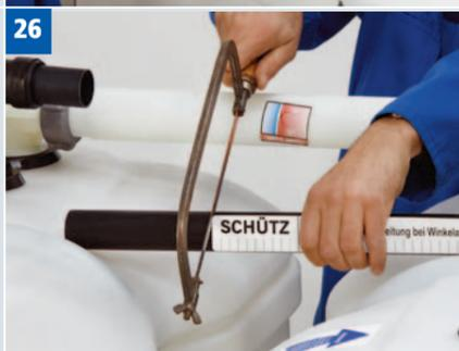
26) En configuration "L", raccourcir le tuyau d'aération selon la mesure de la règle fournie.
