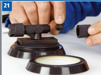
21) Fermer l'extrémité du T d'aspiration à l'aide d'un bouchon et d'un écrou mobile.
