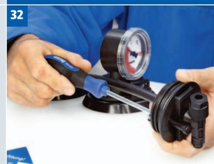
32) Faire sortir le bouchon de l'unité d'aspiration supplémentaire en poussant du côté intérieur à l'aide d'un tournevis.
