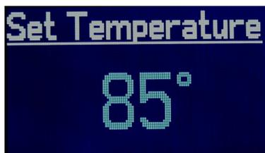
*S'il y a une installation activée au réservoir pour ECS, pour avoir un échange de chaleur normal vers l'eau dans le réservoir, la température réglée doit être au moins 5 degrés plus haute que la température réglée au menu **DHW Setup** domaine **Set Temp**.*
