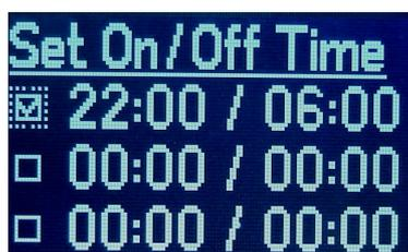
Puis confirmez votre choix en appuyant sur le bouton **F**, et il va apparaître un écran pour sélection de l'installation externe qui doit être chauffée. Vous sélectionnez de la même façon comme dans le mode **Auto**. Dans ce mode, au coin supérieur gauche de l'écran apparaît l'heure d'exécution de l'opération suivante, soit allumage (**On**) ou arrêt (**Off**) du brûleur:
