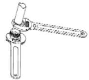
Vananın montaj yönüne uyunuz. **CIAT** vanaları üzerinde sirkülasyon **A → AB** (A batarya tarafına ve AB hidrolik ağ tarafına bağlı) olmalıdır). Vanalarımız (açık ya da kapalı) üzerindeki izin verilen maksimum diferansiyel basınç 100 kPa'dır. **CIAT** 60 kPa'nın aşılmamasını tavsiye etmektedir.
