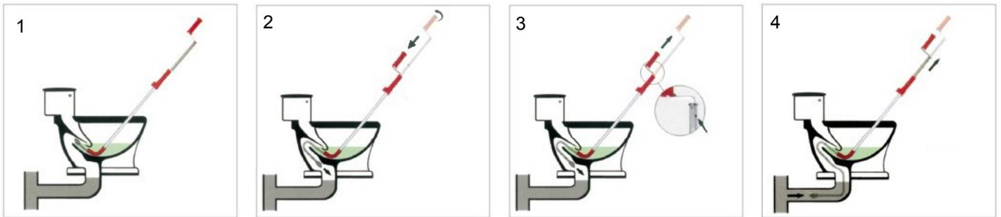
1. Sortez la manivelle du tube, jusqu'à ce que la tête articulée touche le tube. Introduisez le tube dans la cuve des toilettes.
