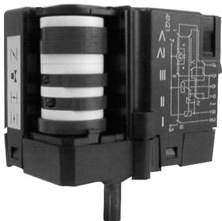
Le servomoteur STA sert au réglage du débit d'air ou à la commande de l'électrovanne sur les brûleurs à deux allures avec exclusion d'air. Le réglage s'effectue par l'intermédiaire de cames de fin de course sur l'axe du servomoteur.
