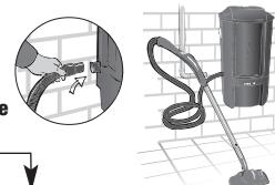
3. - Sluit de slang aan op de van het netwerk losgekoppelde centrale
