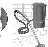
3. - Csatlakoztassa a gégecső tömlőt a rendszerhez nem csatlakoztatott központi szívőegységhöz.
