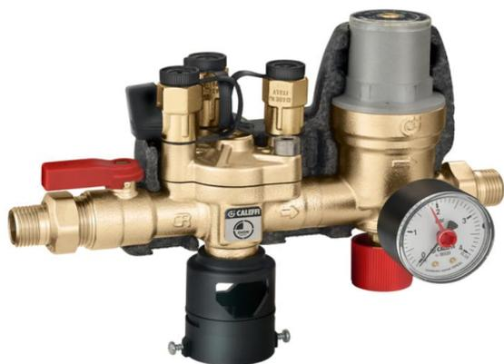
Le rôle de l'alimentateur est de maintenir stable la pression d'eau du circuit de chauffage en le réalimentant automatiquement si nécessaire. Alors que le disconnecteur à zone de pression réduite de type BA empêche en cas de différence de pression de renvoyer l'eau du circuit de chauffage dans le réseau d'eau de ville.
